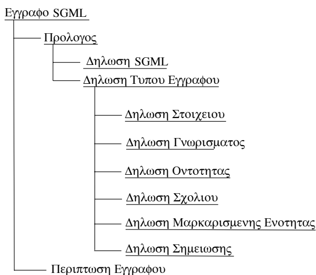
Σχήμα 2.1: Γραφική παράσταση της δομής ενός εγγράφου SGML
